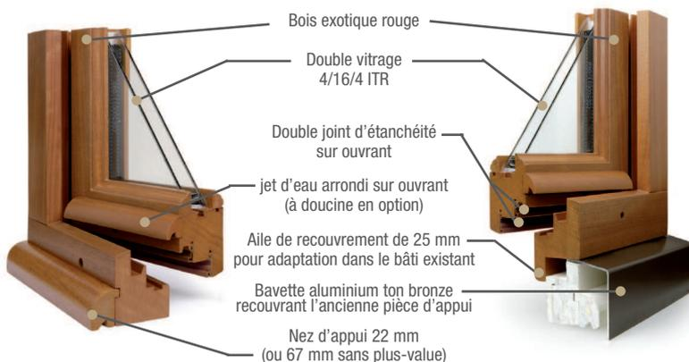
Le profil **RENOVATION** est conçu pour une adaptation dans le bâti existant (lorsque l'état de ce dernier le permet). Une bavette aluminium laquée blanche ou bronze dissimule l'ancienne pièce d'appui tout en assurant sa conservation par une bonne ventilation. Son profil élancé permet de limiter la réduction du clair de vitre.
